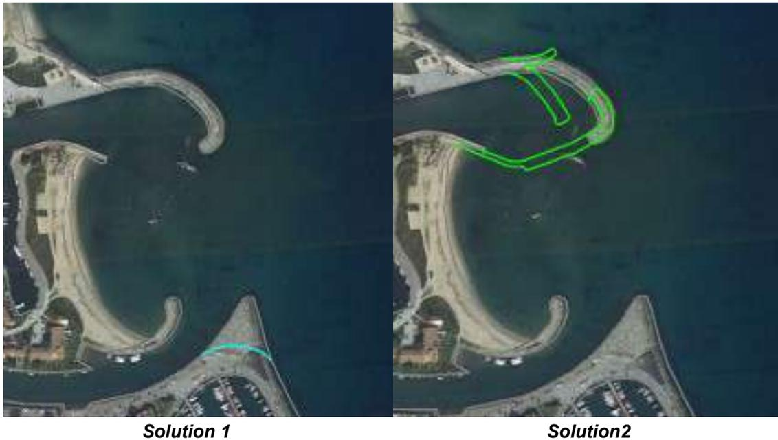
Figure 3 - Solutions identifiées pour réduire l'ensablement de la zone
