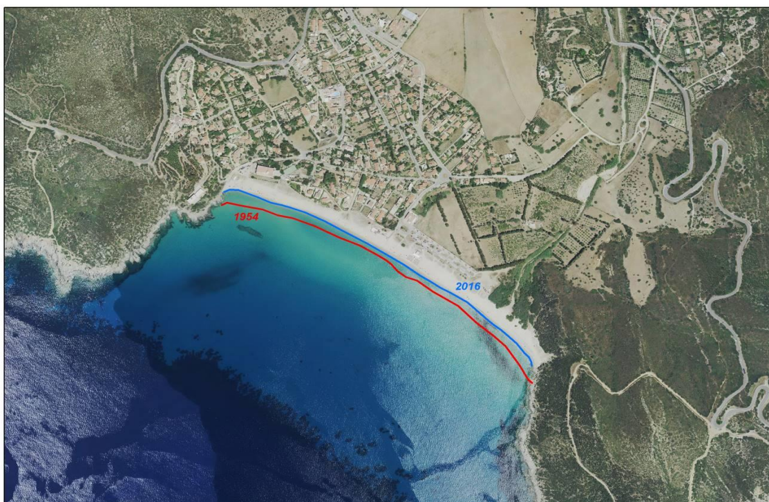
Illustration 15 - Une autre situation d'intérêt, en relation avec l'évolution de la bande côtière, est mise en évidence à la plage de Solanas. L'analyse diachronique 1954/2016 montre un recul net de la côte.
