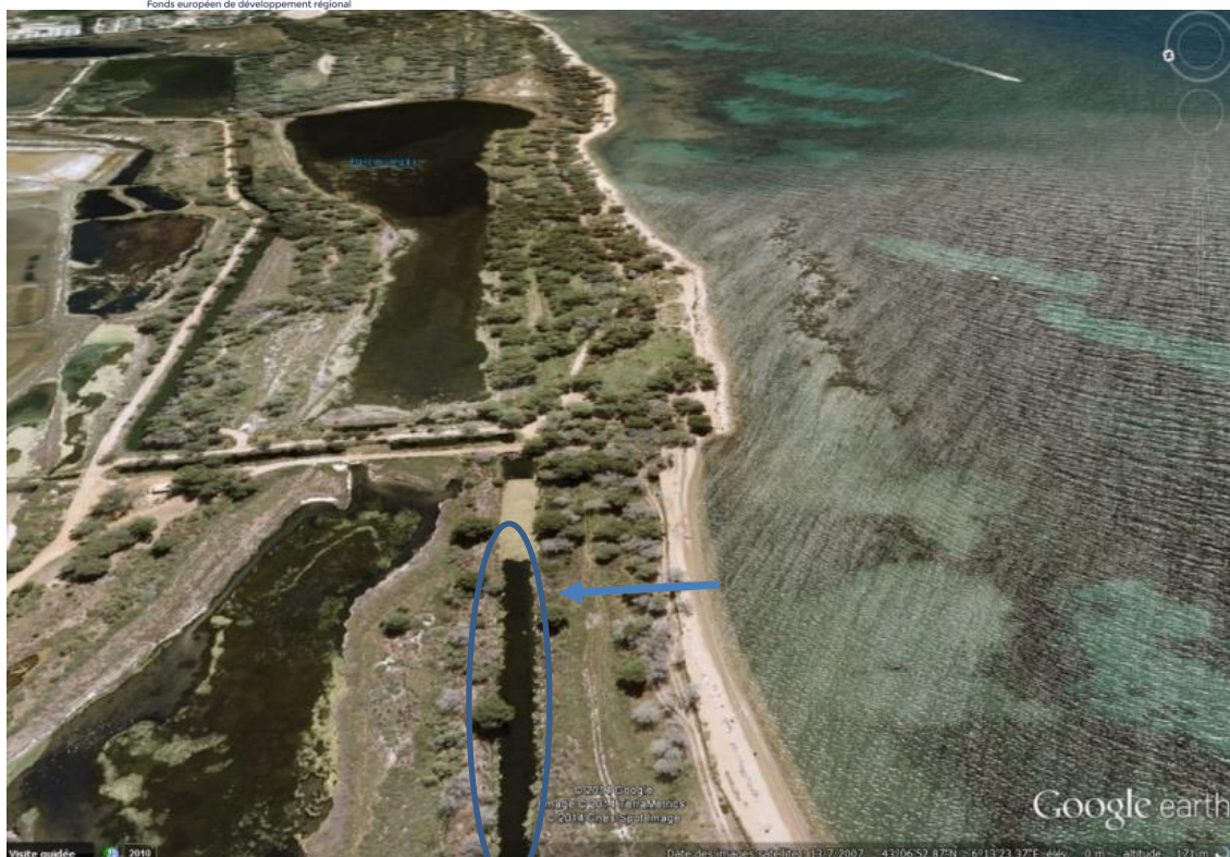
Illustration 3 : Vue aérienne de la partie érodée du cordon littoral avec risque d'intrusion marine au niveau du canal d'alimentation (en bleu).
