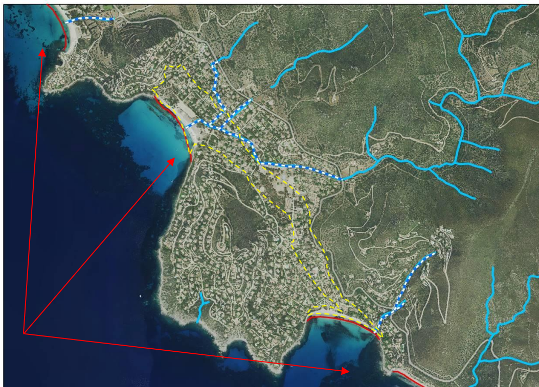
Illustration 10 - Dans les deux images 1954/2016 les modifications anthropologiques du réseau hydrographique, la disparition du compendium dunate derrière les plages de Genn'e Mari (au sud) et de Cann'e Sisa (au nord) et le recul évident de la ligne.
