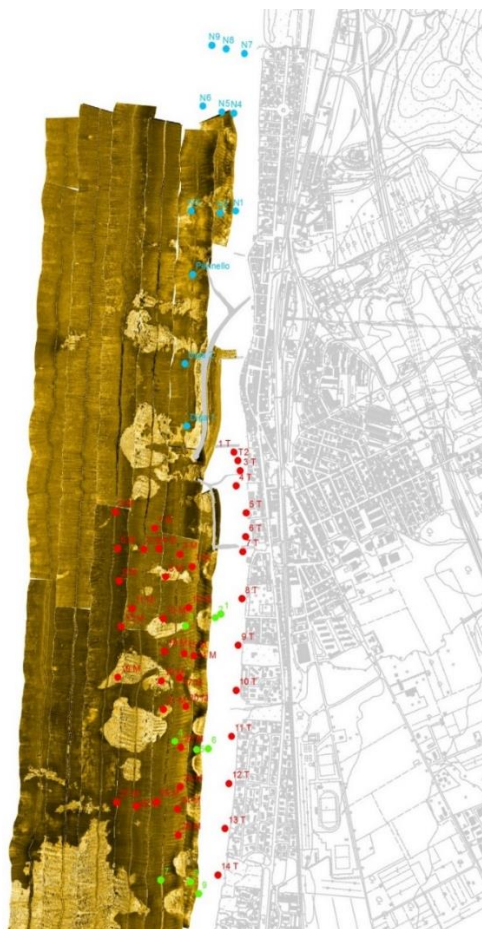
Illustration 5. Mosaïque de Sonar à Balayage latéral en relief nord et au sud du port.
