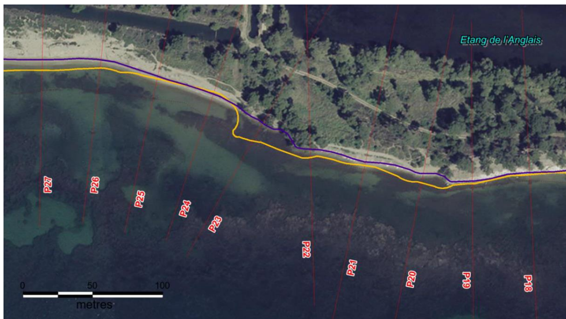
Illustration 9 : Position du trait de côte au niveau du linéaire non protégé par des bétons/ gravats
