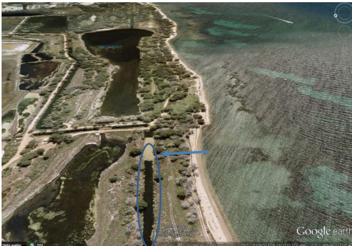
Figura 3: Veduta aerea della parte erosa del cordone litoraneo con rischio di intrusione marina a livello del canale di alimentazione (in blu).
