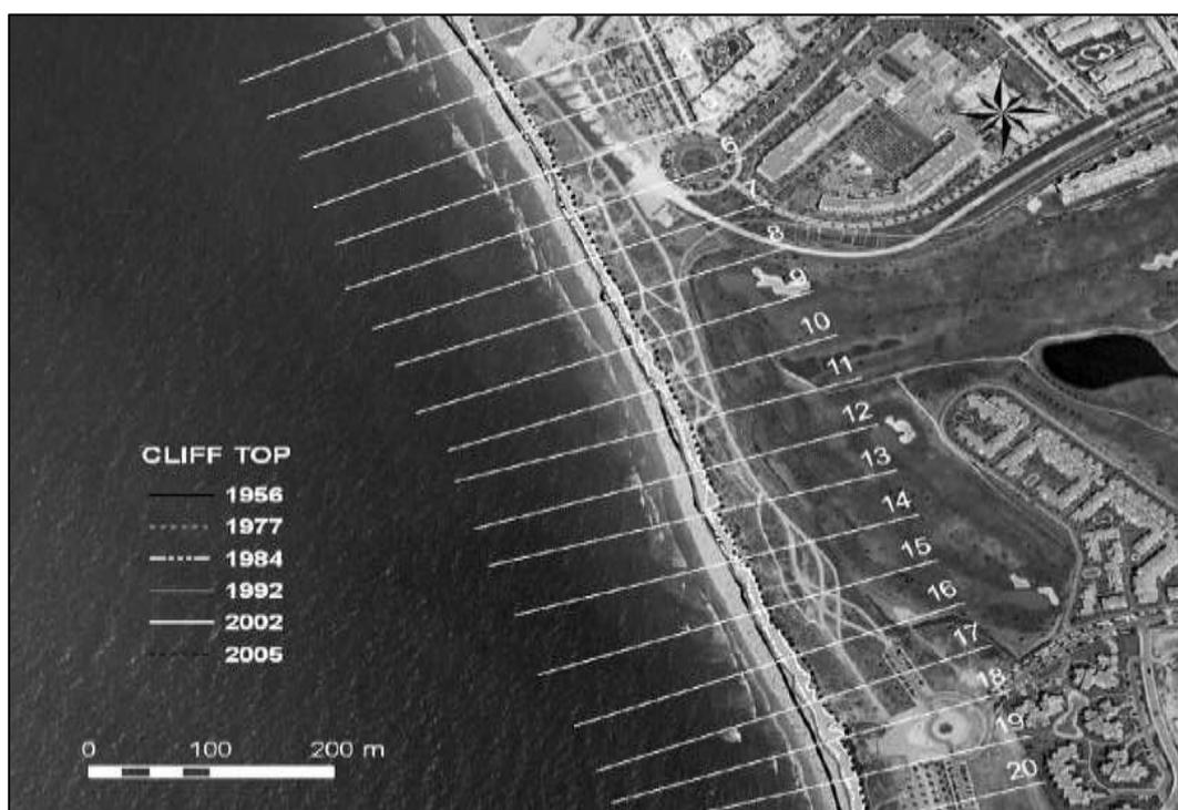
Figure 16 - Exemple d'évolution historique du bord de la falaise entre 1956 et 2005 et transepts de perpendiculaire à la côte le long de laquelle les mesures ont été faites.
