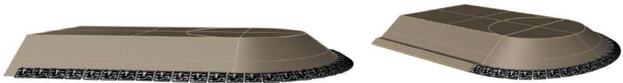
Figura 20: rendering in 3D dei moduli disposti in piede di scarpata dell'estensione sottomarina del pignone Bonaparte (opzione 1 a sinistra, opzione 2 a destra)
