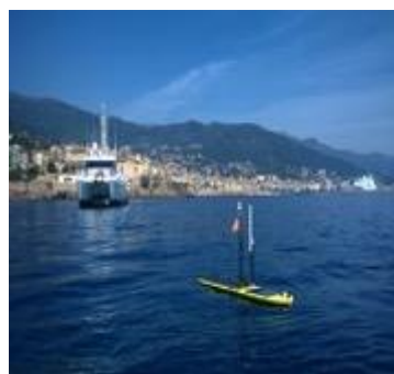
Misure tramite ASV per calibrazione/validazione modelli anche in condizioni estreme
