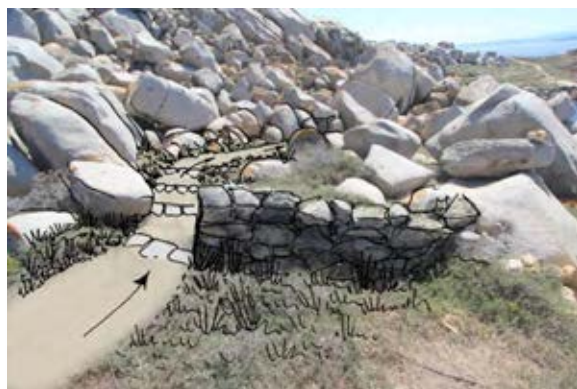
ETAT PROJETE : Restauration du muret en pierre sèche et aménagement du sentier entre les rochers.
