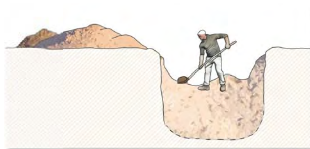
Fase 1) Costruzione della fornace
