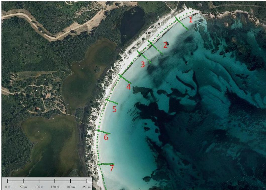
**FIGURE 8: les traces d'acquisition des profils pour le calcul du run-up à Cala Brandinchi**
