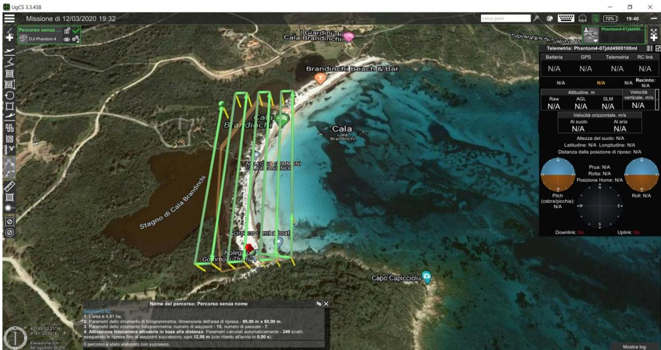
Figure 30 – Planification des vols grâce à l'utilisation du logiciel UgCS 3.3.438.
