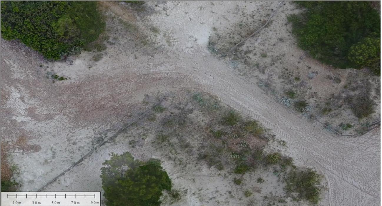
*Figure 26- Impact causé par des véhicules sur la plage ; Forces de cisaillement verticales et horizontales appliquées sur la surface par les pneus.*
