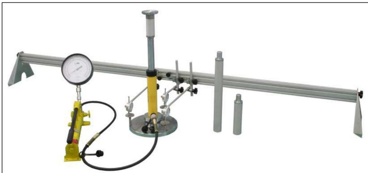
Figure 58 - Équipement utilisé pour effectuer des essais sur des plaques de 300 mm, des treillis et des supports de comparateurs millimétriques, cric et pompe hydraulique avec manomètre de précision.
