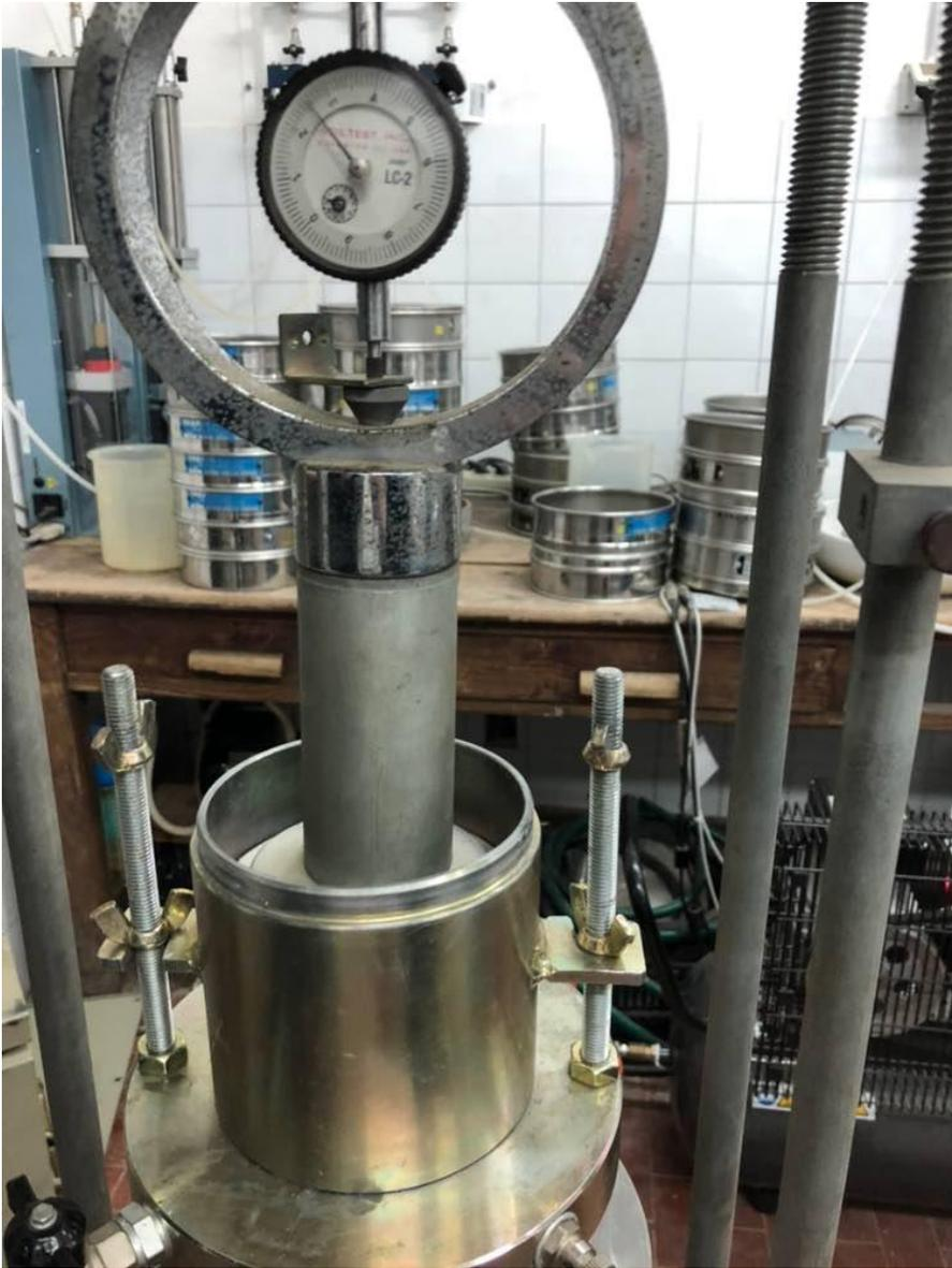
Figure 43: Application d'une charge statique sur l'échantillon.
