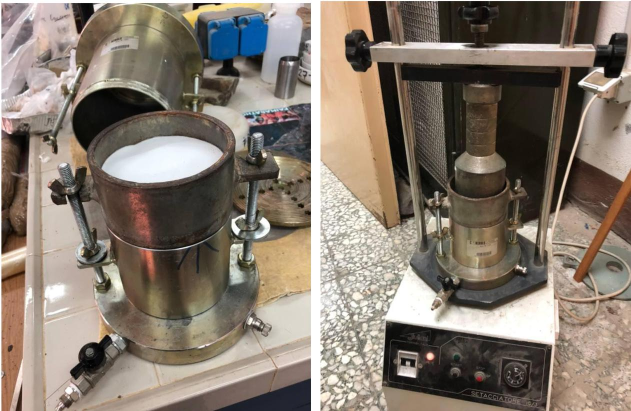
Figure 44: les différentes étapes de l'épaississement par vibration, la préparation de la matrice (première image) et l'exécution de la vibration (deuxième image)
