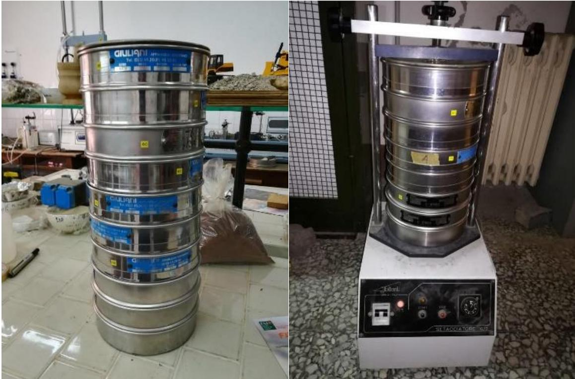
Figure 40: Exécution du tamisage des échantillons.
