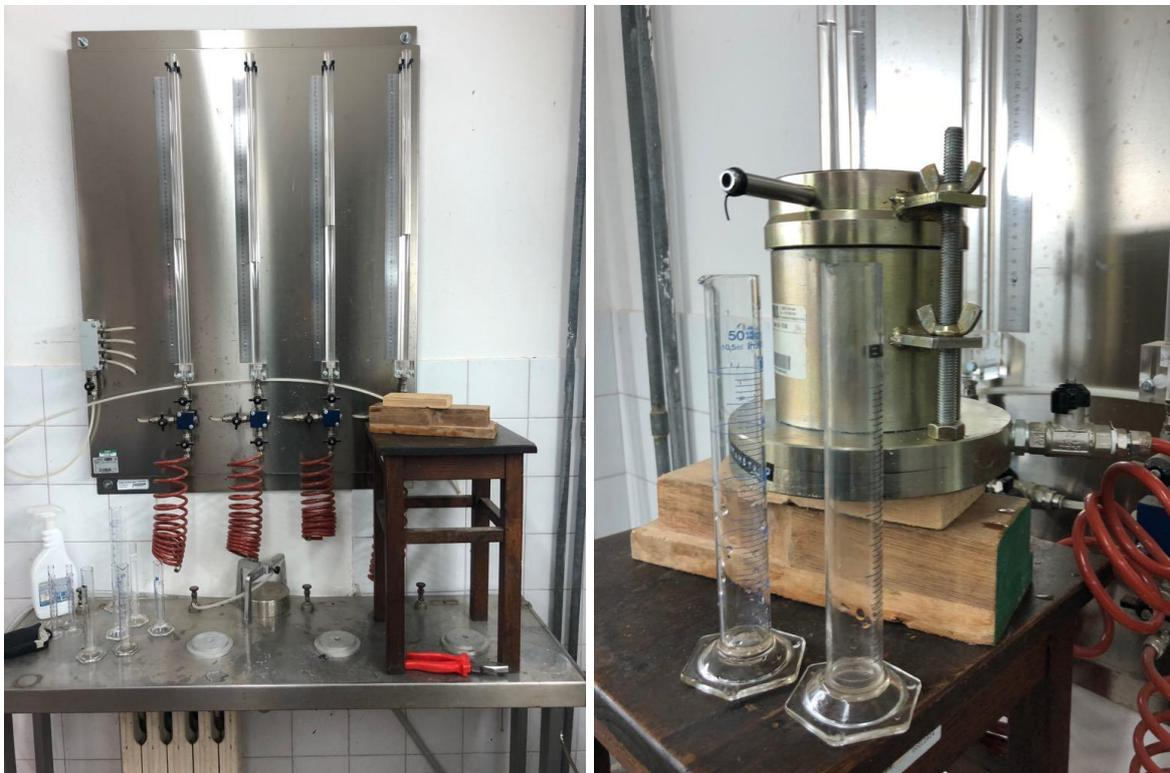
Figure 45: Instruments utilisés pour effectuer des tests de perméabilité.
