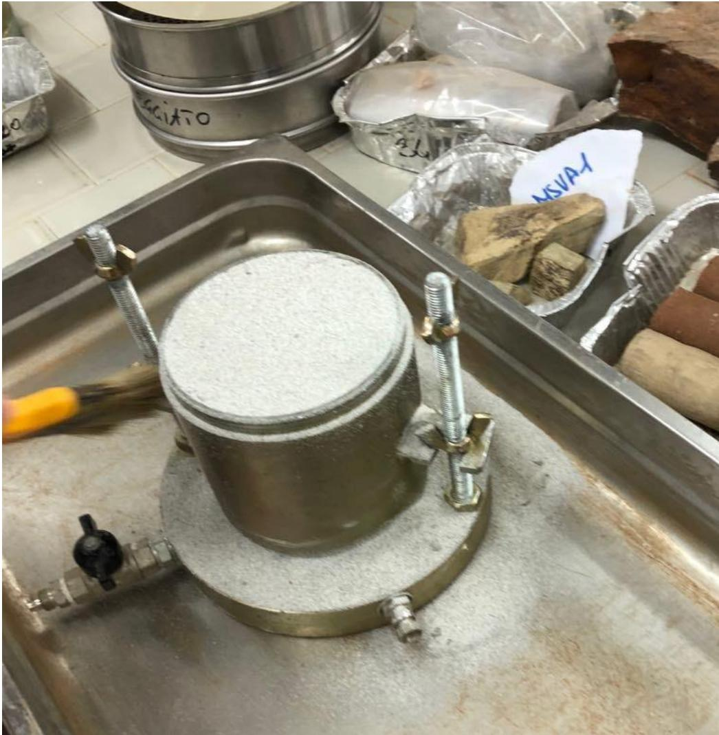
Figure 42: Préparation de la matrice pour le test de perméabilité.
