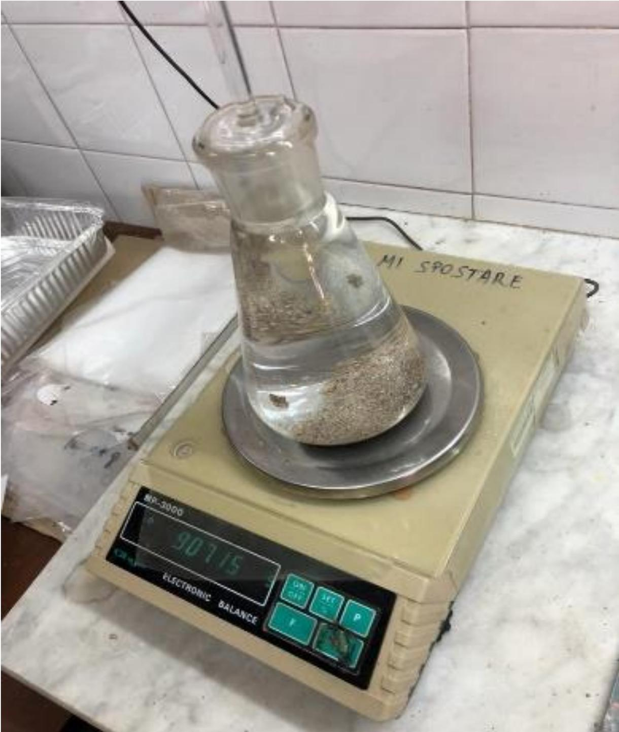
Figure 41: Pesée du pycnomètre.
