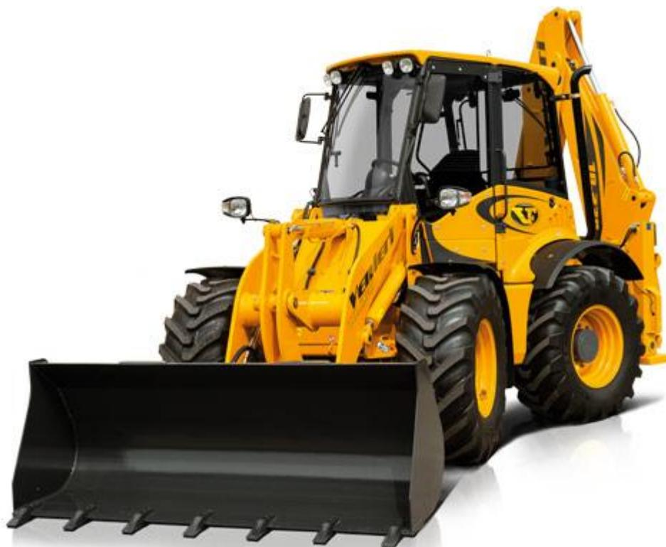
Figure 57 - Une chargeuse pelleuse à roues, d'un poids de 8.600 kg, utilisée comme contraste pour effectuer les tests de plaque.
