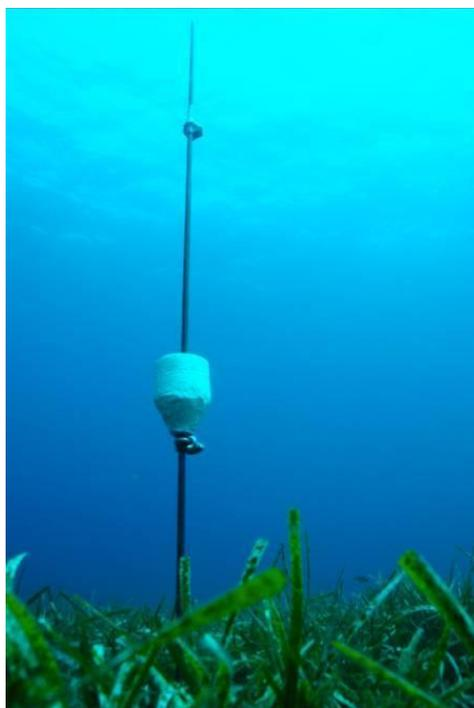
Figure 64. Compacimètre utilisé pour la mesure de la compacité de la matte dans l'herbier.
