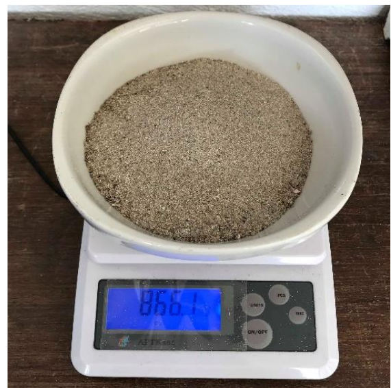
Figure 14 : Pesée d'une fraction sédimentaire issue d'une carotte de banquette de Posidonie et séchée à l'étuve
