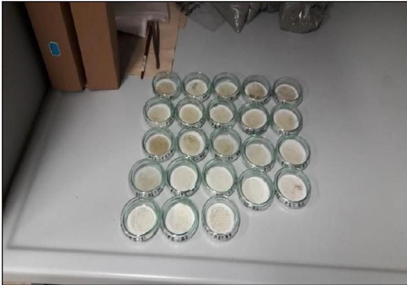
*Fig. 37 - Boîtes de Petri contenant les filtres à analyser.*
