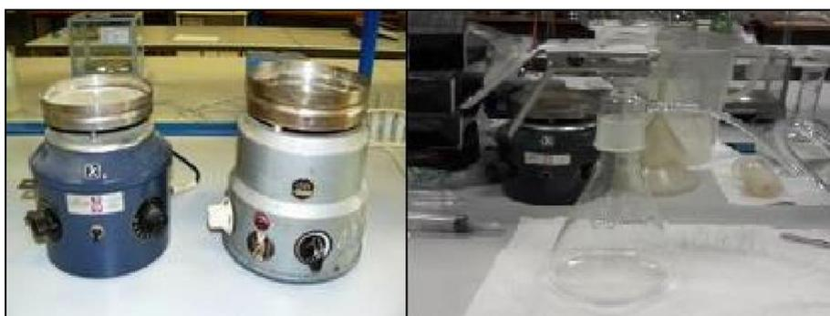
Fig. 36a et 36b - Agitateur magnétique (à gauche) et batterie de filtration avec entonnoir Büchner (à droite)
