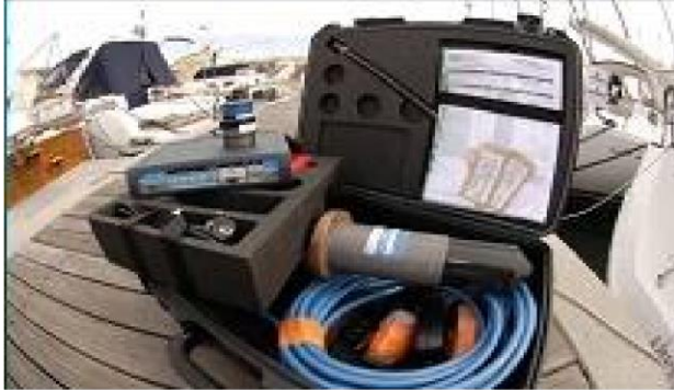
Figure 7 : système de positionnement USBL (le Micronav de Tritech).
