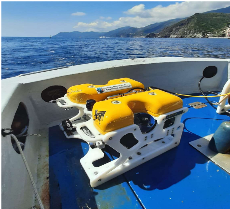
Figura 2. Il ROV Sirio utilizzato per le indagini video-ispettive.
