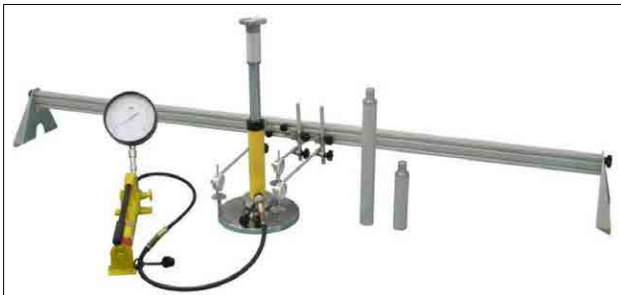
Figura 58 - Apparecchiatura utilizzata per l'esecuzione delle prove su piastra da 300 mm, traliccio e supporti per i comparatori millesimali, martinetto e pompa idraulica con manometro di precisione.
