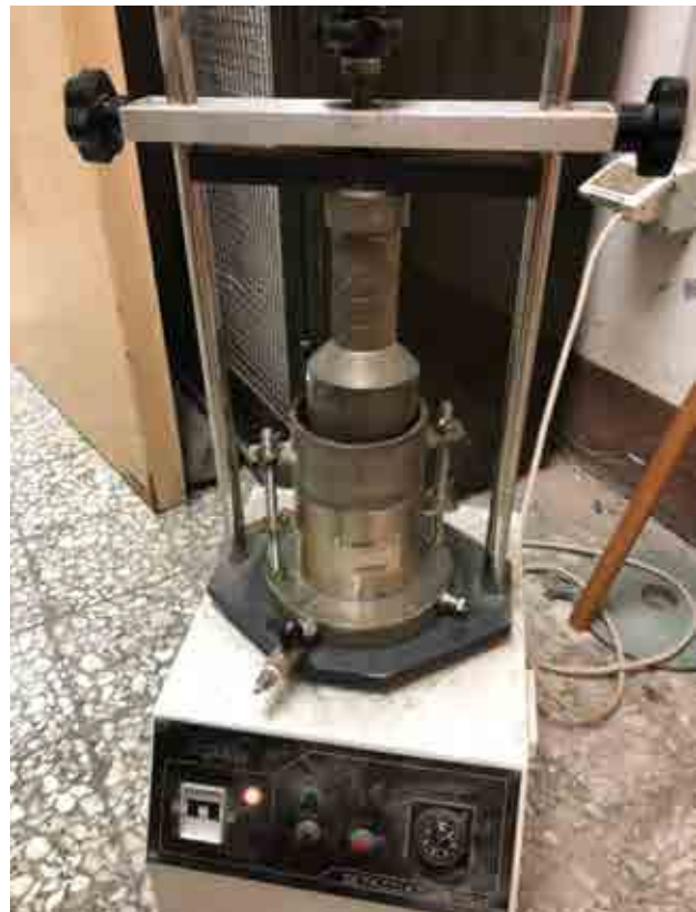
Figura 44: diverse fasi dell' addensamento per vibrazione, Preparazione della fustella(prima immagine) e esecuzione della vibrazione( seconda immagine)
