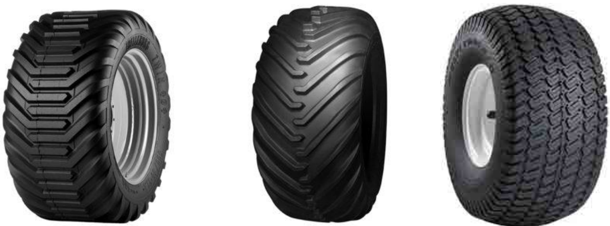
Figura 15 a – tipologie di pneumatici da sabbia ad ampia superficie di appoggio e bassa pressione di esercizio.
