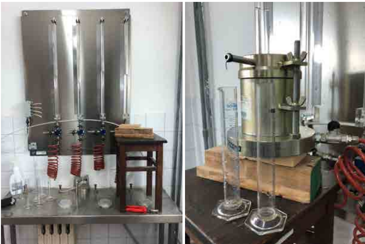
Figura 45: Attrezzatura utilizzata per l'esecuzione delle prove di permeabilità.
