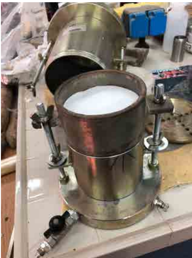
Figura 44: diverse fasi dell' addensamento per vibrazione, Preparazione della fustella(prima immagine) e esecuzione della vibrazione( seconda immagine)
