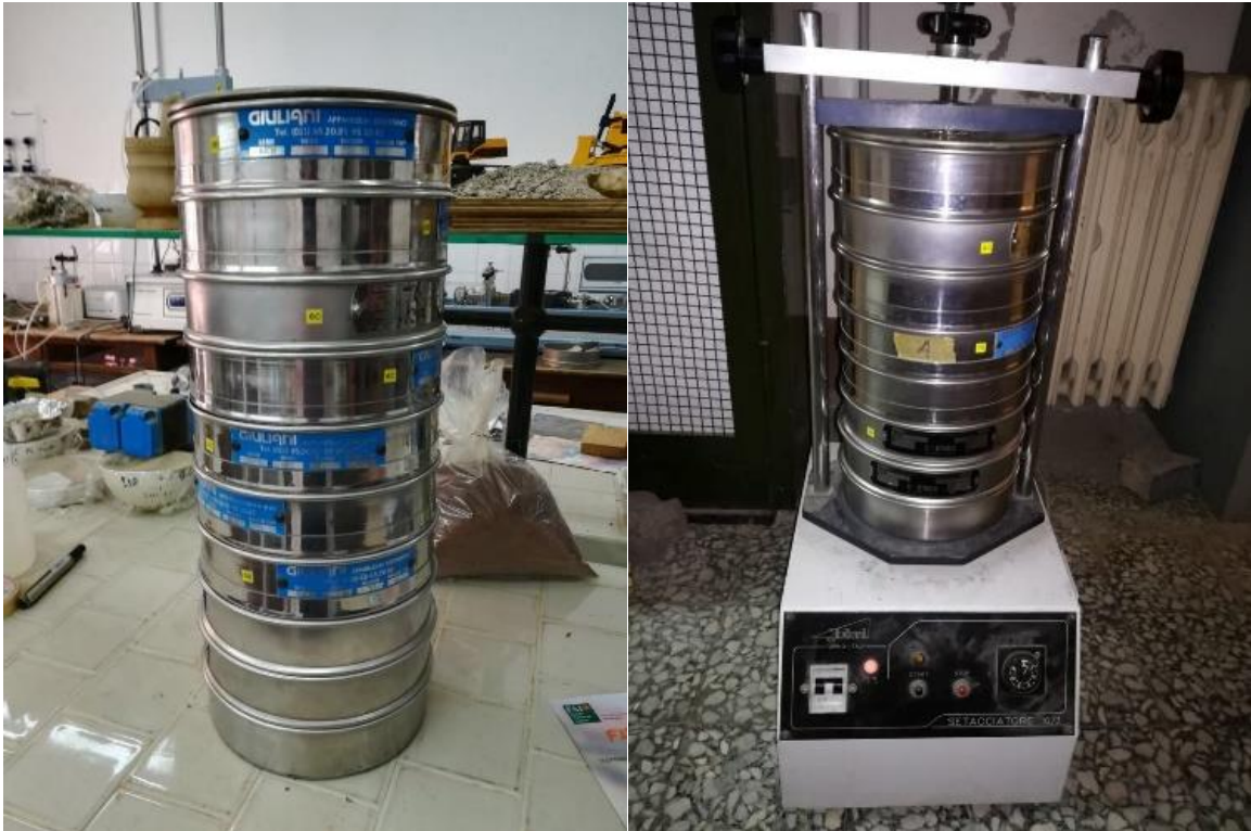
Figura 40: Esecuzione della setacciatura dei campioni.
