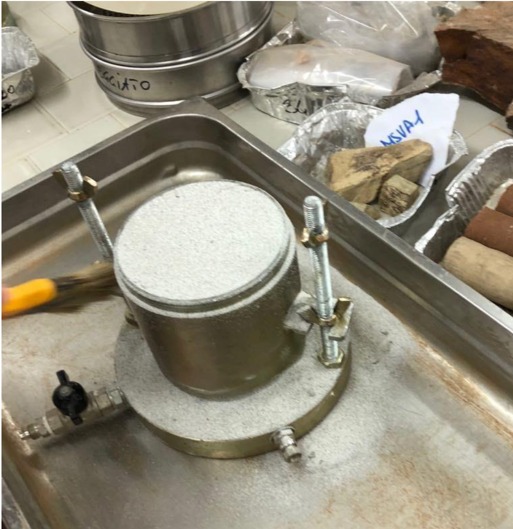
Figura 42: Preparazione della fustella per prova di permeabilità.
