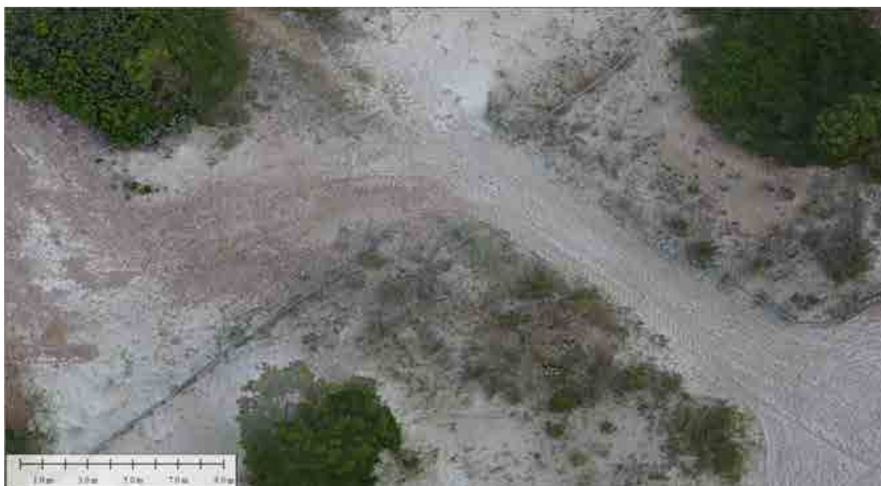
Figura 26- Impatto causato dai veicoli sulla spiaggia; Sforzi verticali e orizzontali di taglio applicati sulla superficie attraverso gli pneumatici.
