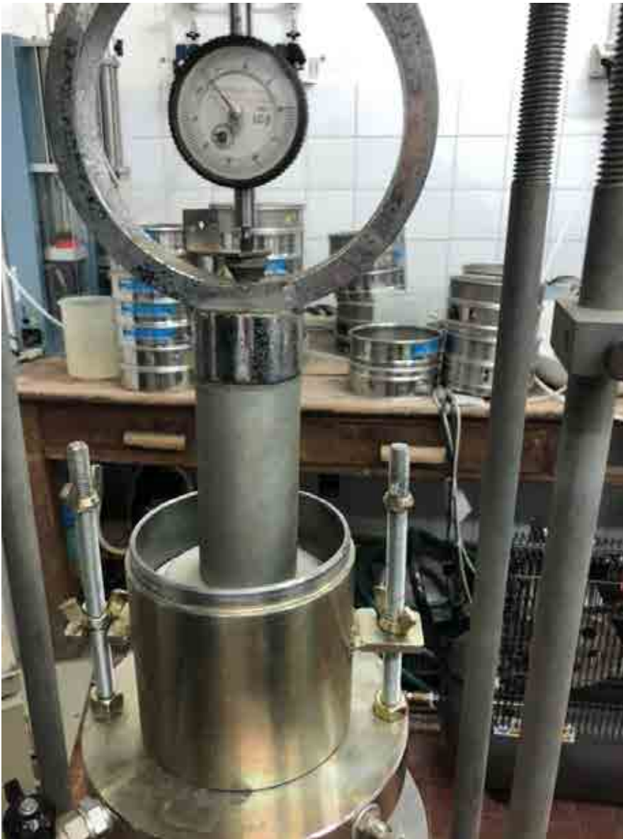
Figura 43: Applicazione del carico statico sul campione.
