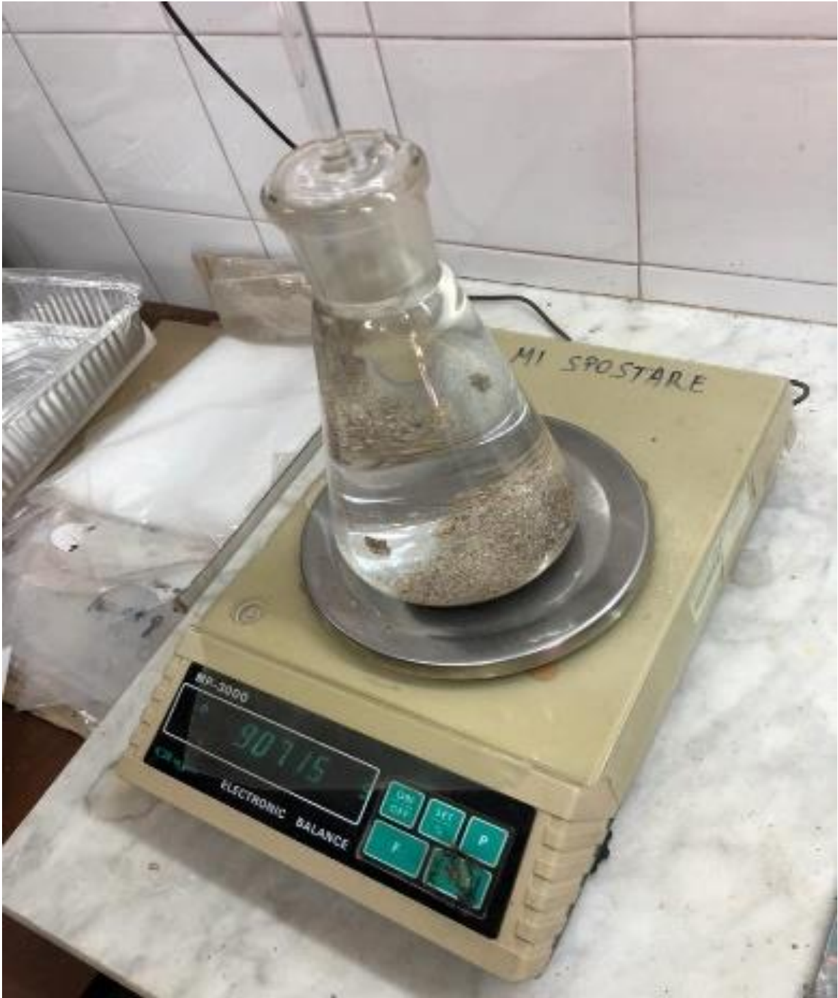
Figura 41: Pesata del picnometro.
