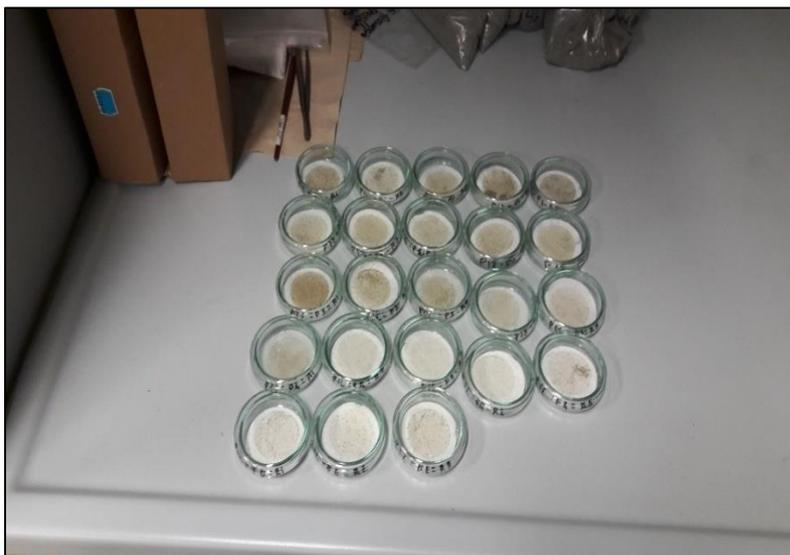
*Fig. 37 - Capsule petri contenenti i filtri da analizzare.*
