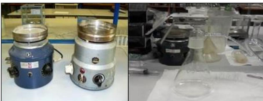
Fig. 36a e 36b - Agitatore magnetico (a sinistra) e batteria di filtraggio con imbuto Büchner (a destra)
