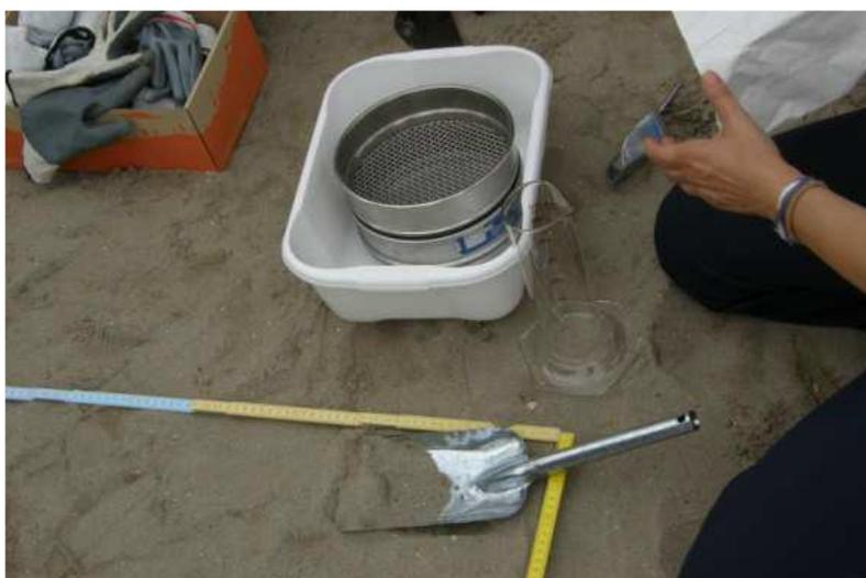
Fig. 34 - Materiali per campionamento delle Large Microplastics e delle Mesoplastiche
