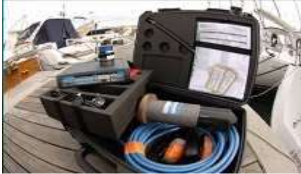
Figura 7: strumento di localizzazione USBL (Micronav di Trittech).
