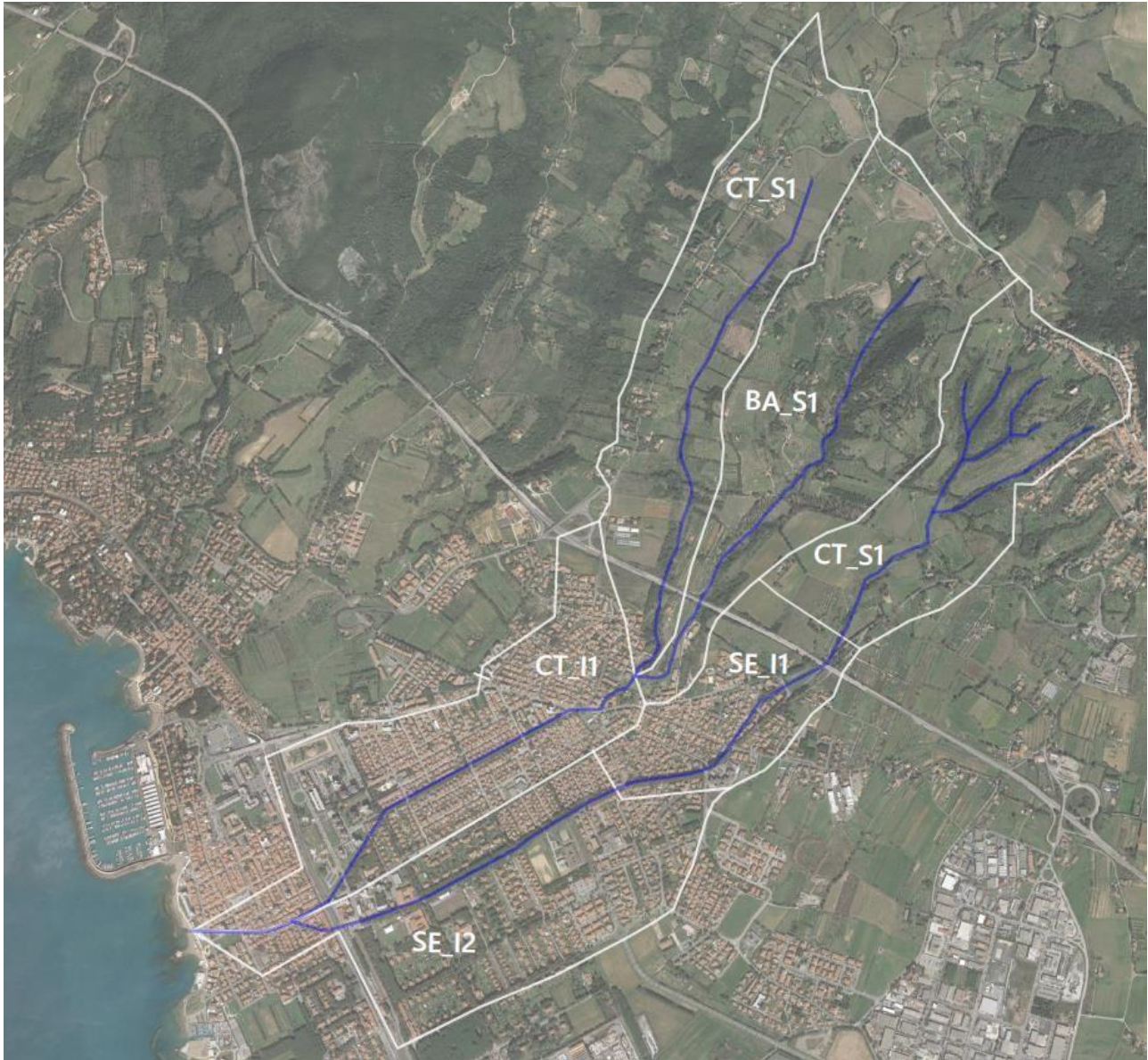
Figura – Suddivisione dell'area in esame in sottobacini (in bianco) e le aste principali (in blu)
