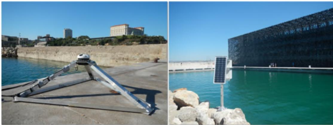
**Figura 5-6 :** Fotografie di un AWAC su un tre elementi di base con il suo cavo e abbinamento elettronico con un pannello solare
