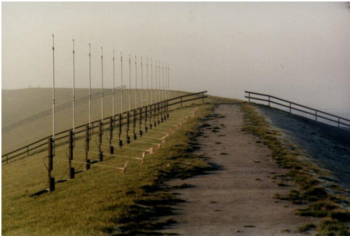
Fig. 3.3b Esempio di radar HF dotato di un array di antenne riceventi (WERA – foto dal sito <http://wera.cen.uni-hamburg.de/>) che utilizza la tecnica *Beam forming*
