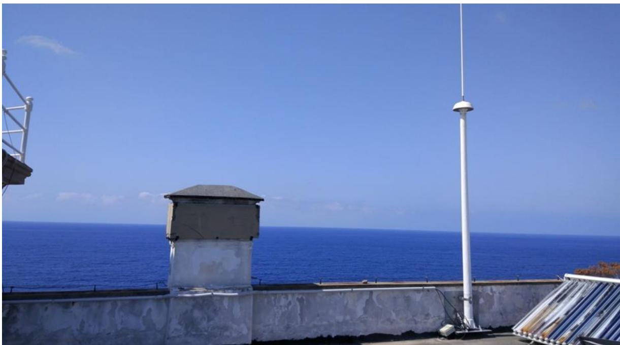
Fig. 3.3a Esempio di radar HF dotato di antenna compatta (Codar SeaSonde) che utilizza la tecnica *Direction Finding*
