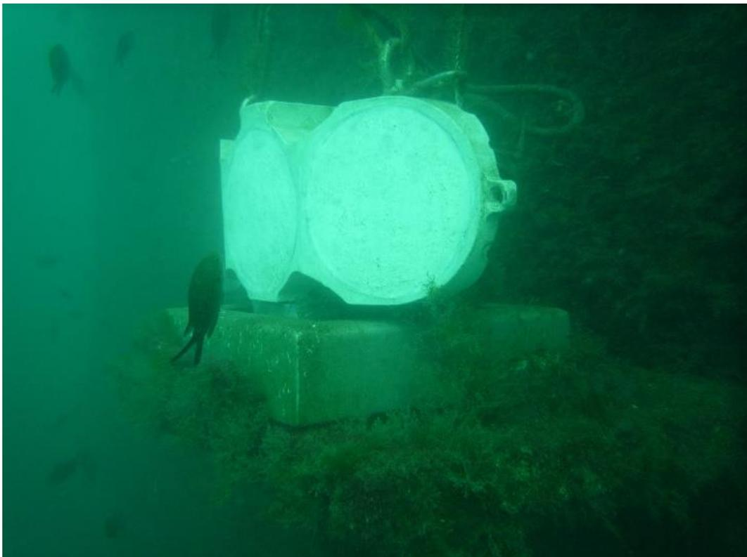
Fig. 2.8 Foto subacquee dell'ADCP orizzontale (Dragaggio Porto di Genova)
